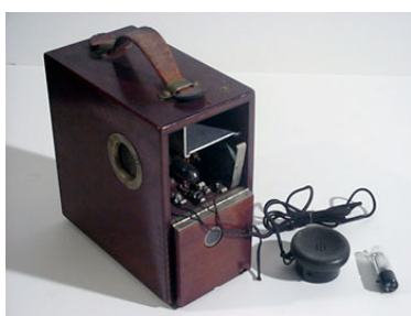
Pierwszy próżniowy aparat słuchowy o rozmiarach 18,4 x 10 x 18,3 cm. wykonany w 1921 roku.
